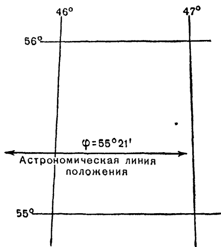
Рис. 58. Прокладка астрономической линии положения на карте по высоте Полярной
