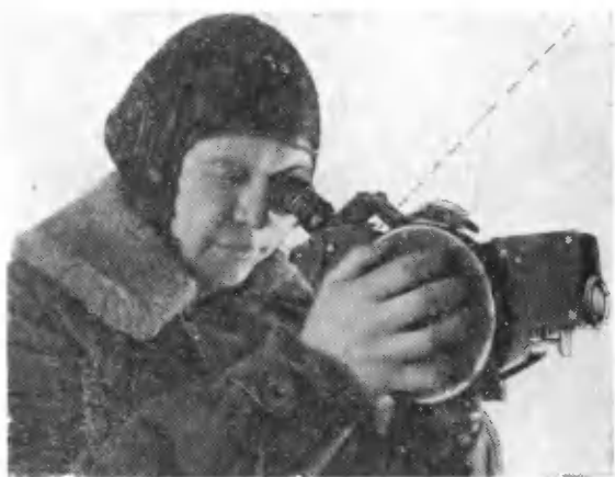
Рис. 34. Измерение авиасекстантом высоты светила
